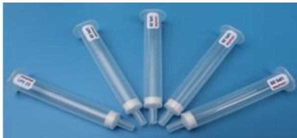
图6.1-2. 凯若泰UPE20萃取柱(3mL, 20mg)照片
