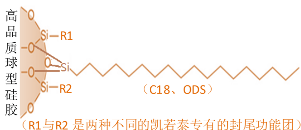
图7.1 (A). 凯若泰™ ODS-RPS固定相的键合示意图
